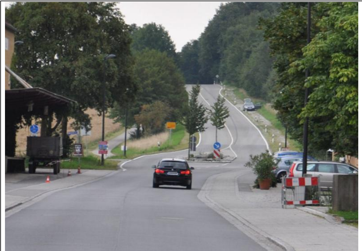
Abbildung 26: Beispiel für eine Verkehrsinsel und Fahrbahnverschwenkung
